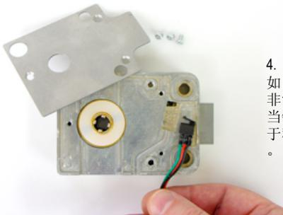
4. 如图中所示，该开关带有一个非常小片的泡沫附着在前面。当钢盖板安好后，该泡沫有助于稳固开关在锁体孔洞中位置。
