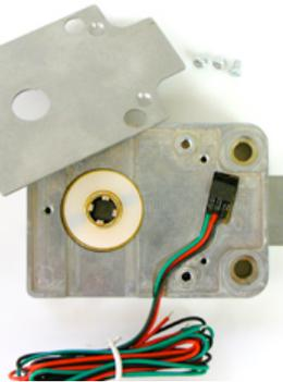
5. 将开关在锁体孔洞中安放到位后，将三线电缆嵌入凹槽中。确保所有三条电线完全嵌入槽内，以便当钢板重新盖上后它们不会被夹坏或压坏。
