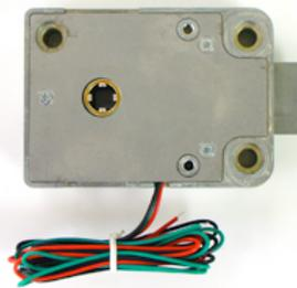
6. 将开关电线留在凹槽内，把钢板放回原位并用步骤 1 中拆下的螺丝把它牢固地安装到锁盒上。
