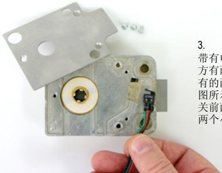
3. 带有电线的开关在小杠杆臂的正下方有两个孔。这些孔要套上锁体固有的两个小柱件，杠杆臂的朝向如图所示。在这张图片中是去掉了开关前面附着的小泡沫垫，以便将两个小孔显露出来。
